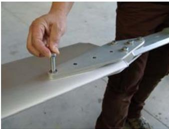
4° : Insérer les vis de fixation par-dessus sans oublier la rondelle sous la tête de vis.
