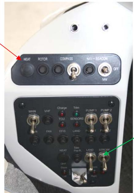
Note : pour le « Vol de nuit » l' interrupteur STROBE ( → ) sur la façade auxiliaire n' alimente que les feux à éclats
