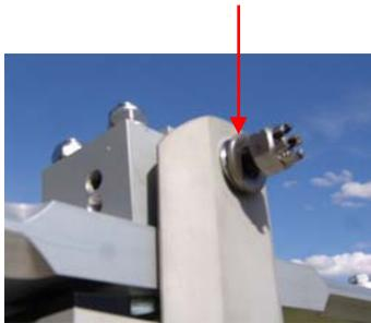
3° : Mettre en place la rondelle Z12 ( —→ ) et l' écrou à créneaux.
