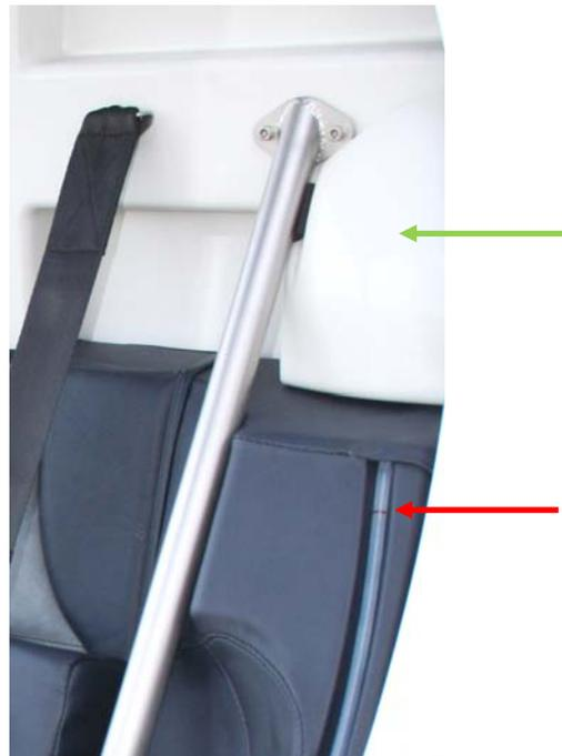
Note : pour les vols de longue durée, seul à bord, un réservoir d' appoint amovible, souple, conçu pour l' usage aéronautique, type « Little-Buddy 10.5 Gal (40 litres) TURTLEPAC, peut être attaché sur le siège arrière.
