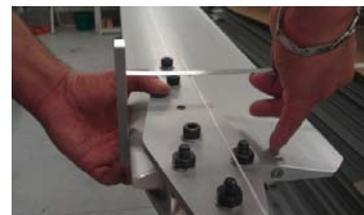
Note : Si la cote n' est pas identique, desserrer légèrement les vis de fixation de la pale. Protéger le porte-pales avec un morceau de bois, puis taper légèrement avec un maillet sur le bord du porte-pales pour déplacer la pale en latéral.
