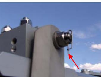
4° : Serrer l' écrou sans bloquer de façon à aligner le trou de la vis, puis **positionner la goupille de sécurité**
